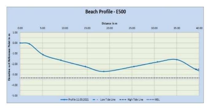
FIGURE-3.8 BEACH PROFILE – EAST 250 & EAST 500 METERS FROM JETTY 11.03.2021
